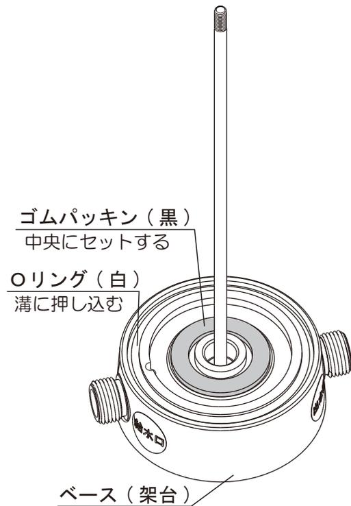
(4) セラミックをベース(架台)中央の溝内にセットして、
