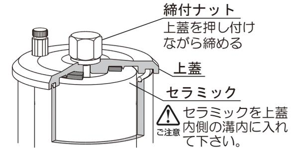
b: その後、スパナ(モンキー)等の工具で、セラミックが動かなくなる程度締付ナットを締めて下さい。
