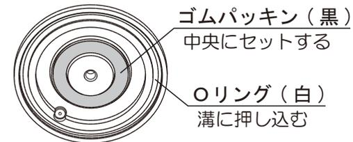
b: パッキンセット後の上蓋を、樹脂本体(透明)の上に乗せて、樹脂パッキン(白)を軸に差し込んで締付ナットを付けます。
