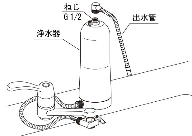
(2) 本体の給水口と浄水器を、給水ホースで接続します。
