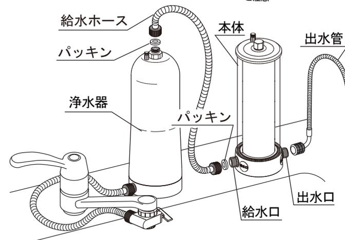
⚠ 給水口と出水口を逆に接続すると浄水器が破損します。
