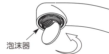
(1) 蛇口先端の泡沫器をコイン等で回しながら外して下さい。
