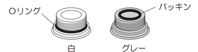
(3) 切替コック(本体)からキャップを外し、アダプターを切替コックのキャップに通して、蛇口の先端にアダプターをコイン等により取り付けます。
