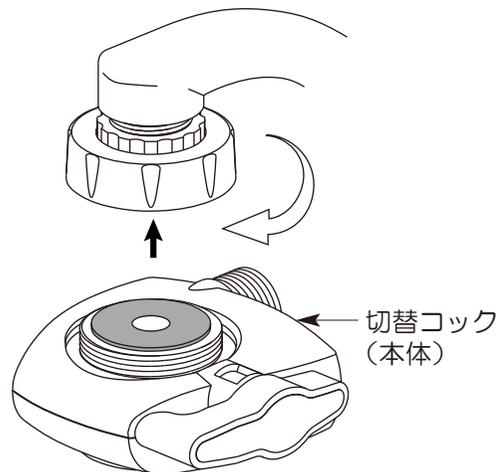
(1) 蛇口先端の泡沫キャップを手で回しながら外して下さい。
