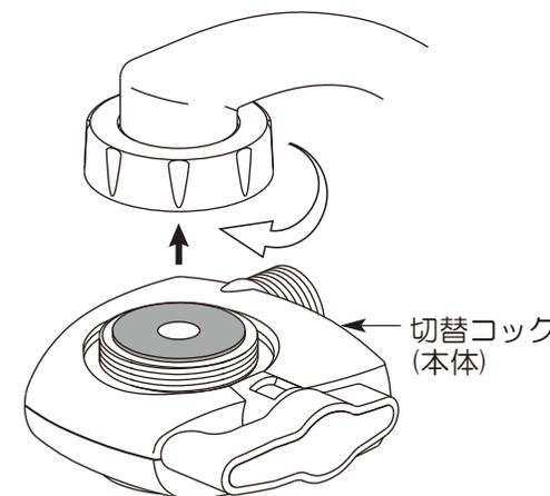
(4) 切替コック本体を水平にしてキャップを回しながら、手で締め付けて下さい。
